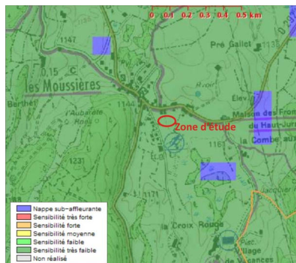
Figure 3 : Phénomènes de remontée de nappe aux Moussières (source : BRGM)
